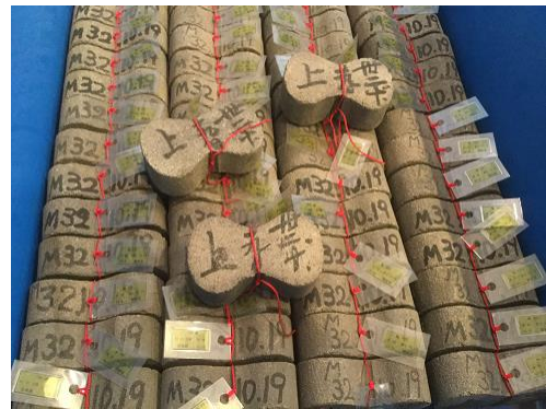
写真-20 モルタルテストピース「ブリケット」
