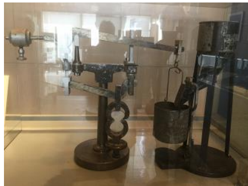
写真-21 ミハエリス二重てこ式抗張力試験機
